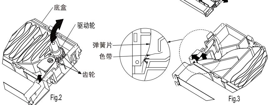
b. 如Fig. 3所示推开弹簧片, 取出色带。
