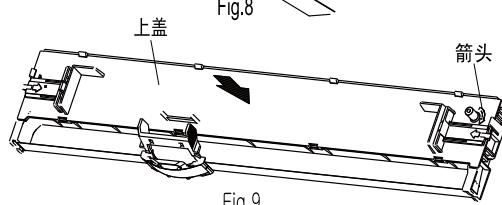
f. 如Fig. 9所示将色带架的上盖盖好, 按箭头方向转动驱动旋钮,
