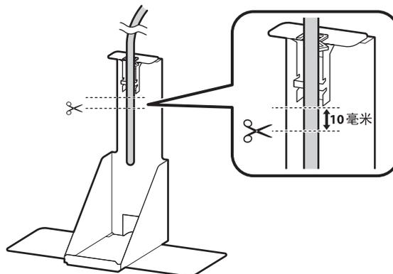
将废墨管放在废墨管固定架旁边，确定合适长度后，如图所示，在距离固定架底部下方约 10 毫米处切断废墨管。
