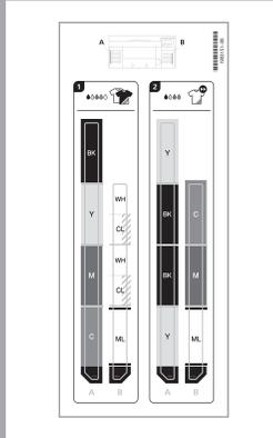
在打开打印机电源之前，在墨包盖内贴上标签，以指示在所需打印机模式下使用的墨水。
