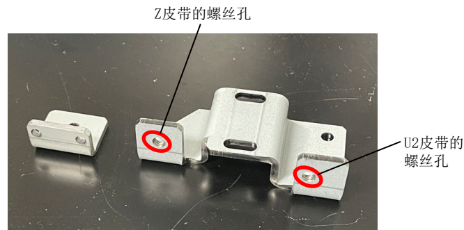
第2关节皮带的夹具 Z皮带/U2皮带的夹具
