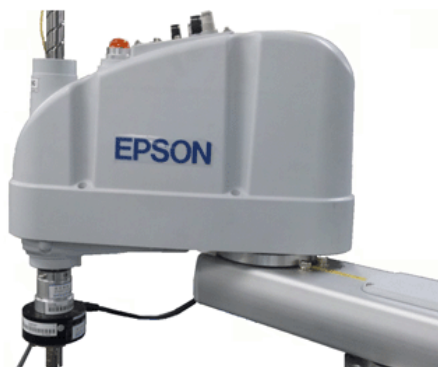
配备伽马力传感器的 SCARA 机器人
