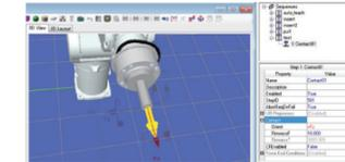
模拟器能快速确认机器人手臂的移动方向和轴坐标。
