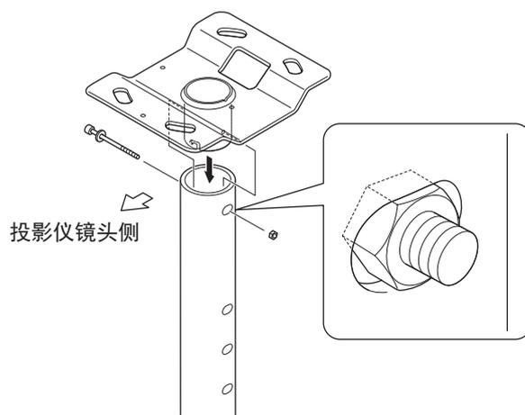
2. 如图所示，将管B安装到倾斜角度调整夹具上。安装时，请使用吊架包装中附带的螺丝。
