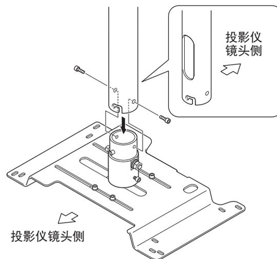
3. 如图所示，使用附带的通孔螺丝和螺母来固定管A和管B。
