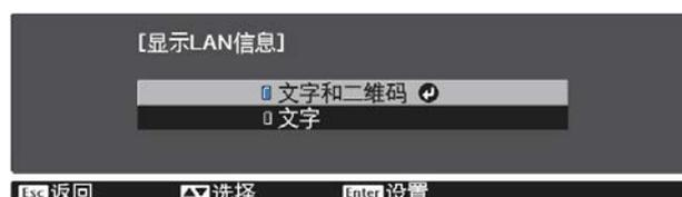
**5** 按下遥控器上的 **LAN** 按钮或选择投影机网络菜单中的**显示二维码**以显示二维码。
