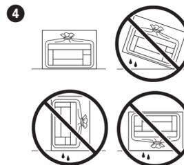
□ 拧紧墨瓶的瓶盖时确保让墨瓶直立。存放和运输本产品时，将本产品与墨瓶分开装在不同的塑料袋中，并使本产品保持水平。否则墨水可能会泄漏。
