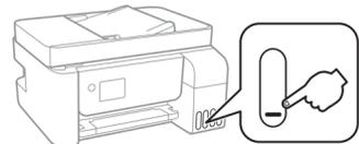
要确认实际剩余的墨量，请目测检查本产品所有墨仓中的墨量。在墨量低于下线时长时间使用本产品可能会导致本产品损坏。
